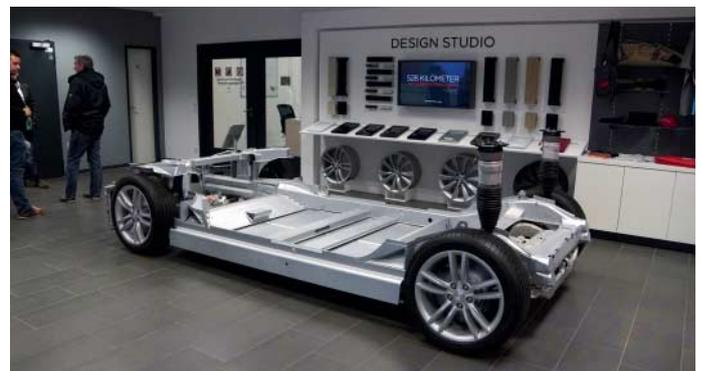
**Die mehr als 6500 Lithium-Ionen-Akkus sind unter der gesamten Fahrgastzelle zwischen Vorder- und Hinterachse montiert.**
