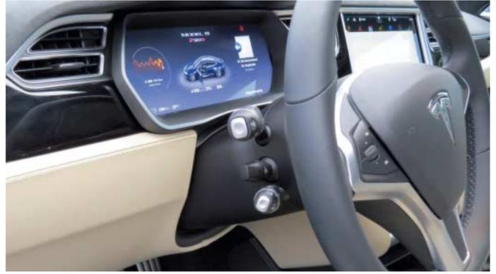
**Durch zweimaliges Heranziehen des unteren Schalthebels auf der linken Lenkrad-Seite aktiviert man den Autopilot des Model S.**
