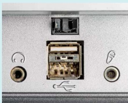
Eine defekte USB-Frontbuchse kann den ganzen PC lahm legen, wenn ein Kurzschluss entstanden ist.
