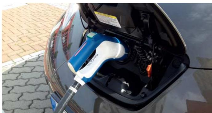
Dank CHAdeMO-Anschluss lässt sich der Leaf in einer kurzen Mittagspause vollständig aufladen.
